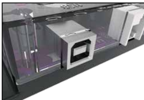
Рисунок 34: Порт USB на контроллере PRIZM, предназначенный для программирования и связи
