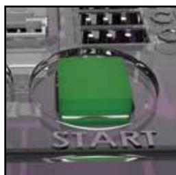
Рисунок 36: Пусковая кнопка на контроллере PRIZM. Включается нажатием.
