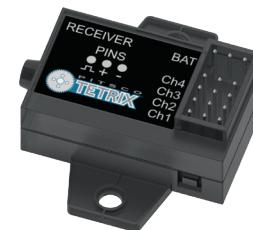
**Приёмник сигналов дистанционного управления серии TETRIX®**
