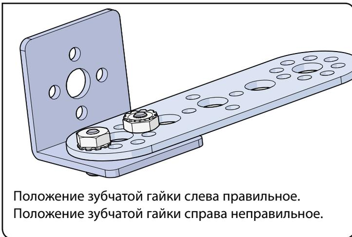
Положение зубчатой гайки слева правильное.
